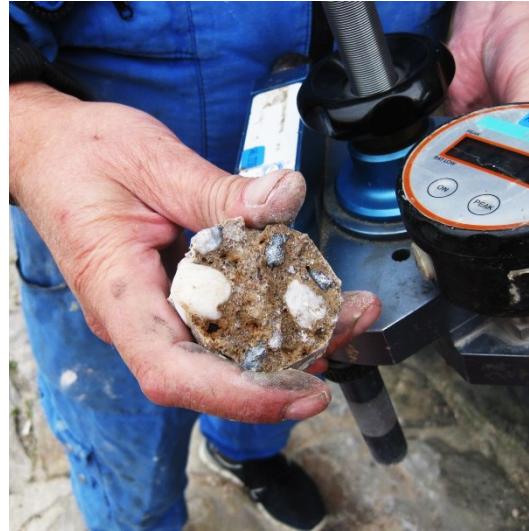
Obr. 10 Spodní strana terče po odtržení
