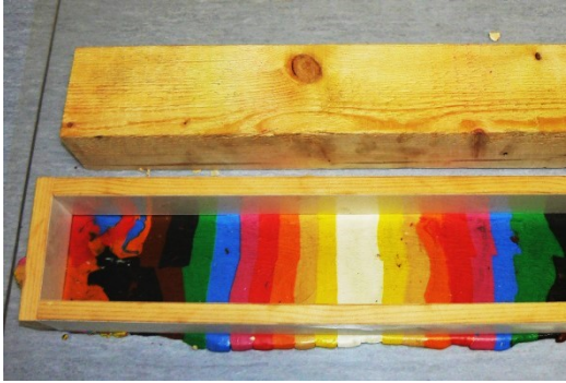
Obr. 18 Na plastelínové lože byl nasazen dřevěný formovací rám pro vymezení plochy silikonového kaučuku.
