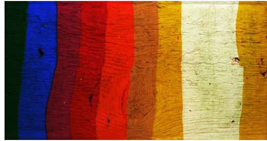
Obr. 19 Dřevěný trám zanechal v plastelínovém loži dokonalý otisk struktury povrchu dřeva.
