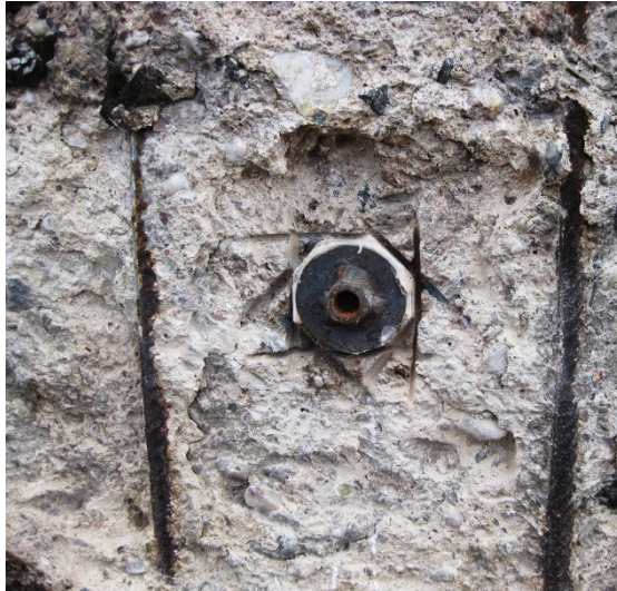
Obr. 9 Nalepený a ořezaný terč
