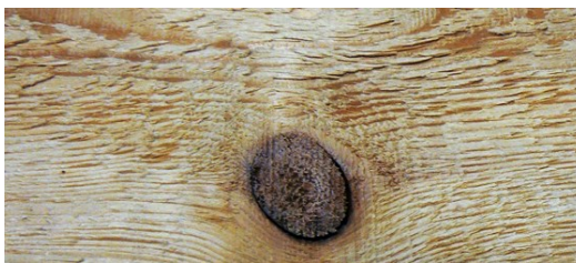
Obr. 16 Pro sejmutí reliéfu nehoblovaného dřeva byl použit trám průřezu 100 x 100 mm.
