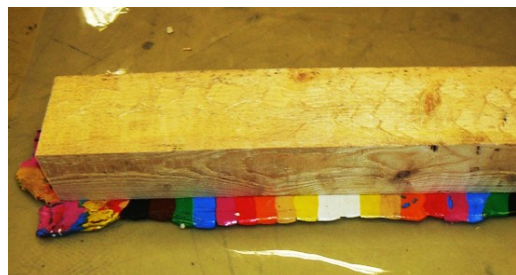
Obr. 17 Připravený trám byl otištěn do plastelínového lože, pro dokonalejší sejmutí struktury dřeva bylo plastelínové lože změkčeno zahřátím horkovzdušnou pistolí.
