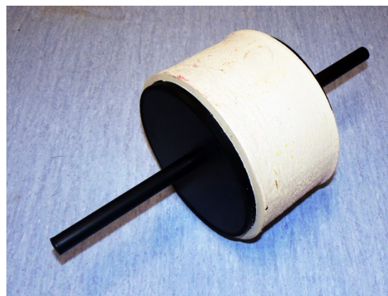
Obr. 23 Finální podoba raznicového válce, umožňující vytváření nekonečného pásu reliéfu otisku dřevěného bednění na povrchu betonu.
