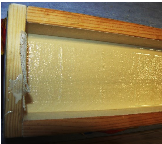
Obr. 20 Do čerstvě nalitého silikonového kaučuku byl ponořen pruh gázy, pro zvýšení tahové pevnosti a odolnosti odlitku.
