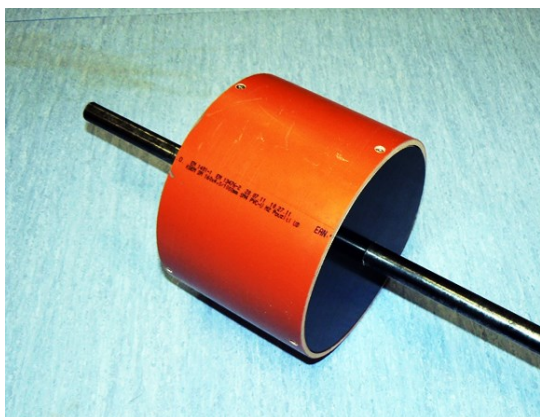
Obr. 22 Sestavený celek nanášecího válce.
